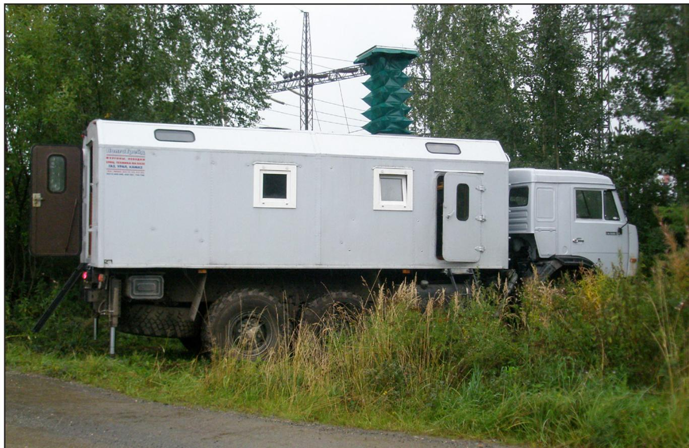
Рис.1. Зондировочная установка УСЗ 15/36А
