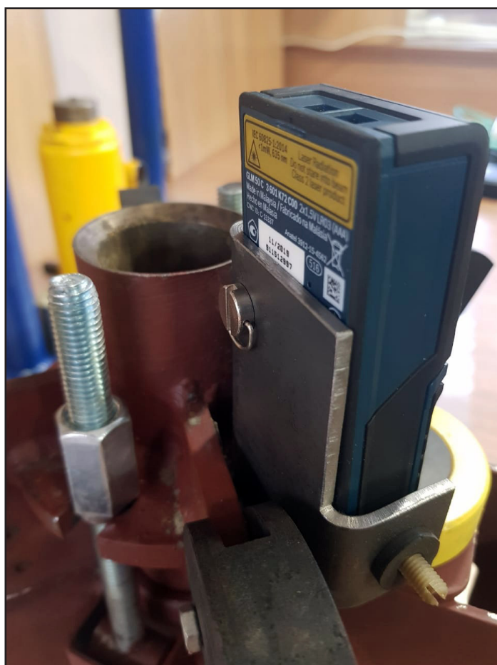
Рис. 1. Крепление рулетки на кронштейне центратора АДЗ-2
