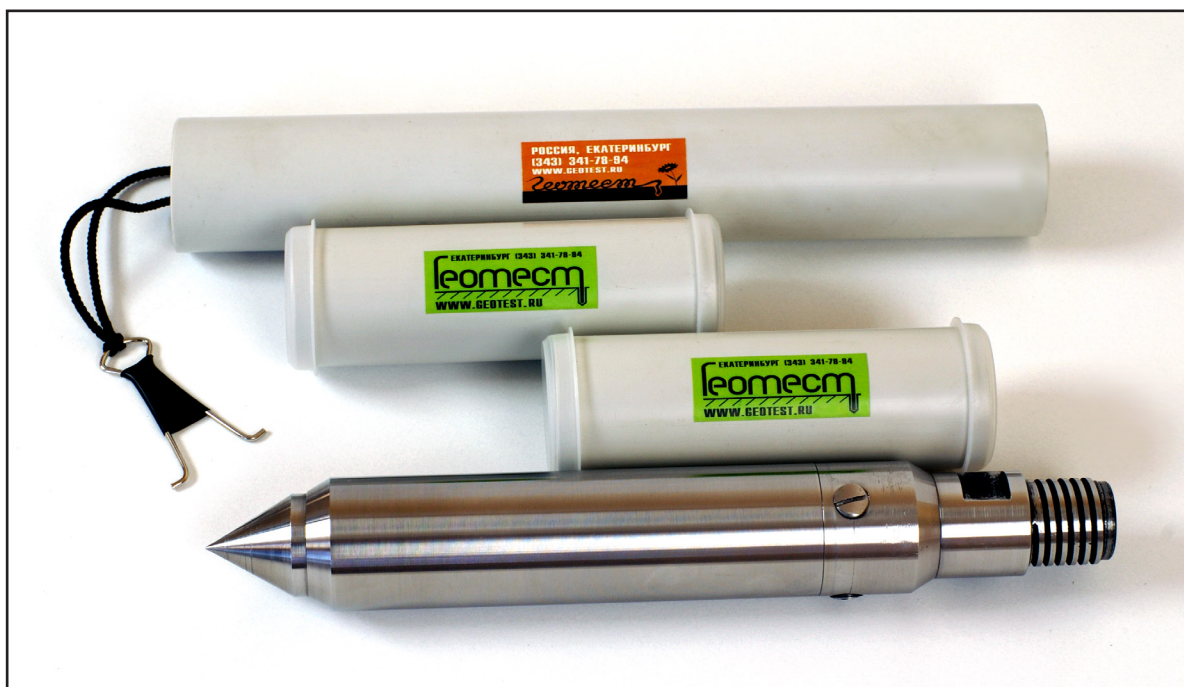
Рис.1. Внешний вид пробоотборника
