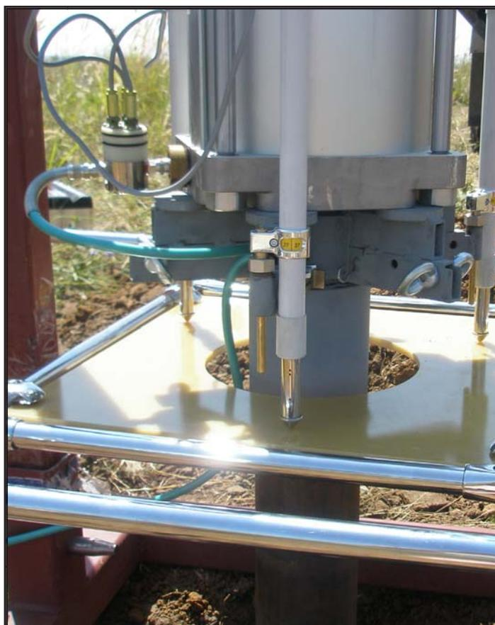
**Рис.3. Измерители перемещений, нагрузочный стол, пневмомагистраль**
